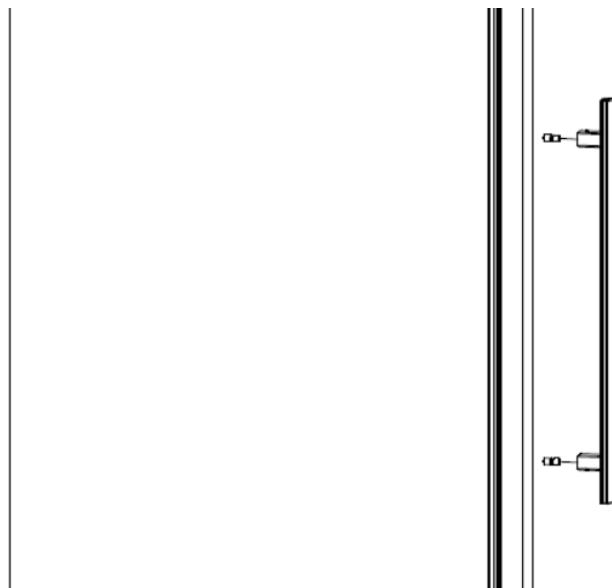
3. Nachdem der Griff an die Schrauben der Tür angebracht worden ist, werden die 2 Schrauben wie folgt befestigt:
